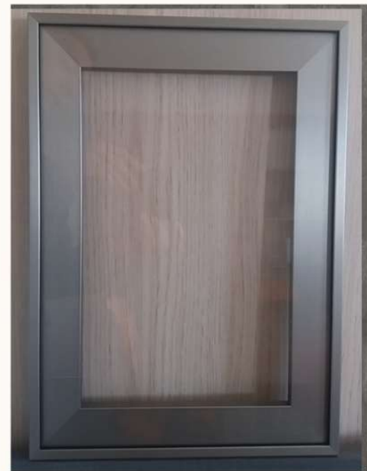
AL 17 - Rahmen aus 20 mm dickem Aluminium, 19 mm breit, Edelstahloptik mit Optiwhite-Glasfüllung.
