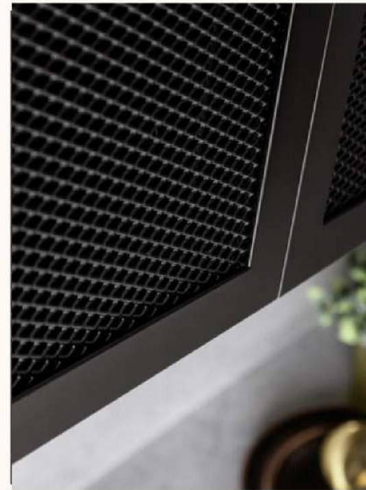
AL 16 - Rahmen aus 20 mm dickem Alu, 19 mm breit, Schwarz eloxiert mit Stahlgitter
