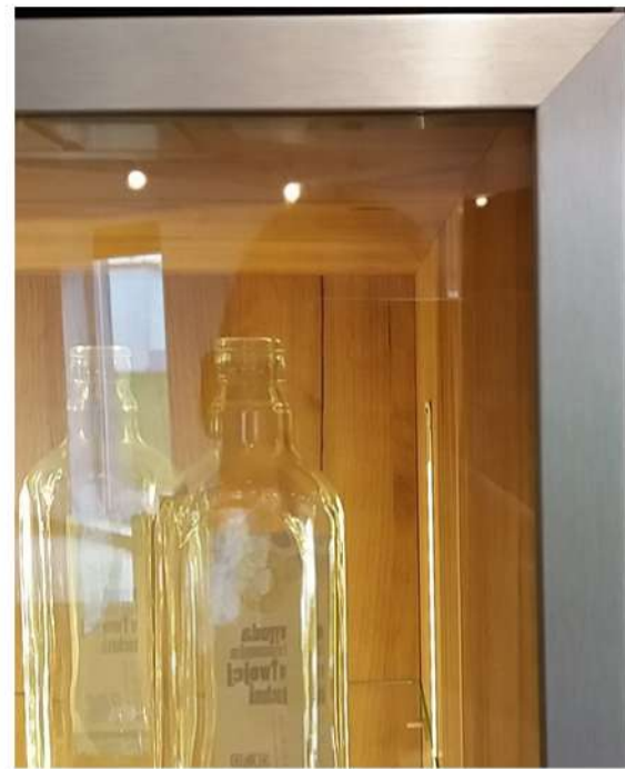
AL 17 - Rahmen aus 20 mm dickem Aluminium, 19 mm breit, Edelstahloptik mit Optiwhite-Glasfüllung.
